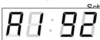
Schrittweise die vier Bytes für die IP Adresse eingeben. Nach Drücken der Tasten **<<** und **>>** auf die nächste Ziffer für das nächste Byte umschalten. Die Bytes sind mit den Buchstaben **A**, **b**, **C** und **d** gekennzeichnet.
