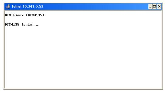
Pour démarrer le menu, dts doit être connecté comme utilisateur. Le mot de passe par défaut est dts (changer le mot de passe → voir chapitre « 6.5.19 Réglages généraux »).
