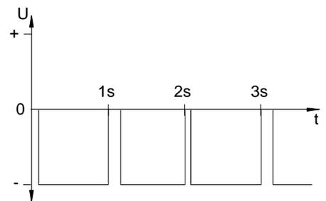
Modi 1/6, 2/5, 3/4 sind gleich. Ihre Polarität ist nur von der Art des Anschlusses am DTS 4132.timeserver abhängig. Die Signalformen zeigen die gemessene Spannung von Anschluss a zu Anschluss b (vergleiche Anhang A).
