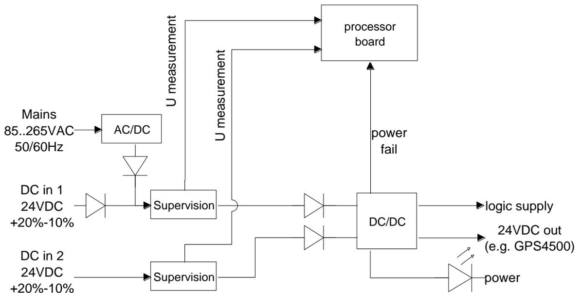
Die Netzspeisung und der DC in 1 Eingang sind intern verbunden, aber gegen Rückspeisung geschützt.
