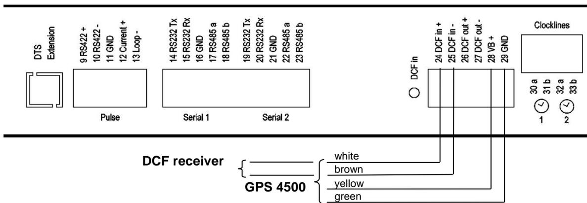
GNSS 3000 gemäss Manual Bx 800813 Kap. 9.2 Anschluss Schemata DCF Current Loop
